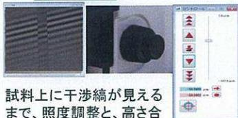
試料上に干渉縞が見えるまで、照度調整と、高さ合わせを行います。マニュアル及びオートフォーカスでの高さ合わせが可能です。
