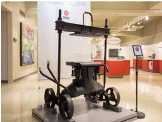
C-11 型 生型造型機
