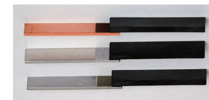
金属（左）と樹脂（右）を接合したサンプル
