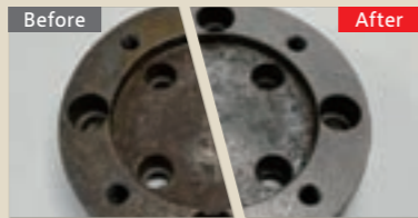
レーザークリーニングによる錆の除去 加工前(写真左)と加工後
