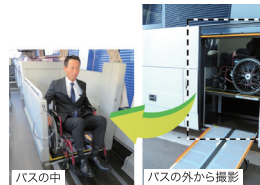
バスの中 バスの外から撮影 エレベータ(リフト)付リムジンバス
