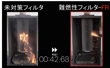
火災対策システムアイテム 難燃性フィルタ
