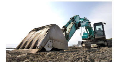
建設機械 車体後部の重り (カウンターウエイト)
