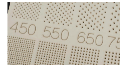
セラミック基板の穴加工サンプル (最小φ 50 μmの加工が可能)
