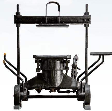
国産第一号造型機 C-11 型 (日本機械学会「機械遺産」認定)
