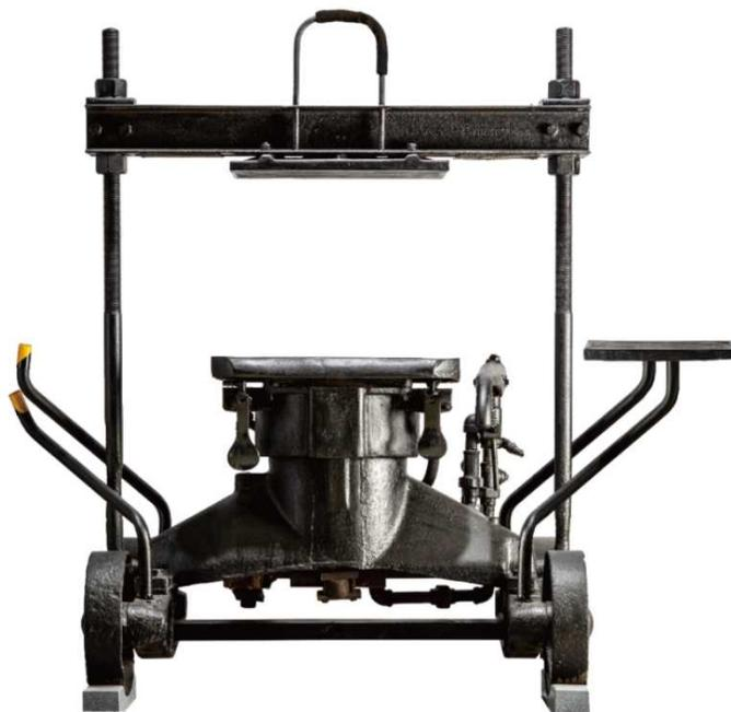
溶かした金属を流し込む砂型を作る機械
