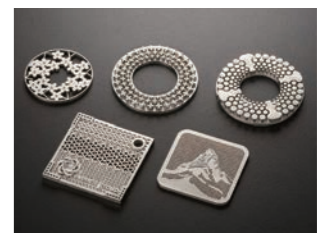
Exentis社製3Dプリンタによる金属サンプル
