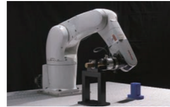
ZYXer®を搭載したロボットによるシャフトの嵌合
