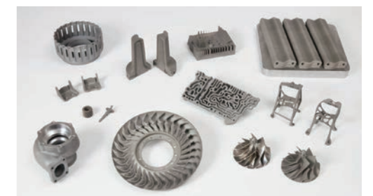
SOLIZE社製3Dプリンタによる造形品に当社の表面処理を施したサンプル
