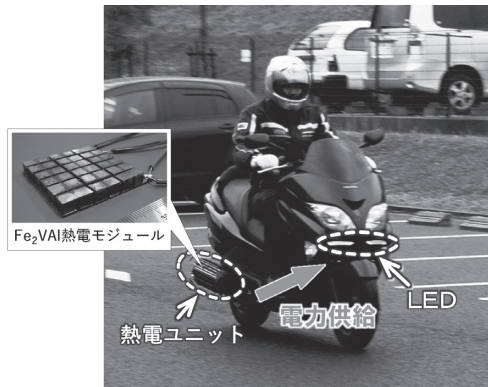
図2 熱電発電ユニットの実車走行試験
