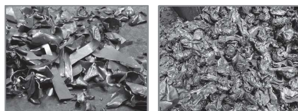
図2 破碎・選別後の鋼板スクラップ (左:高張力鋼板、右:普通鋼板)
