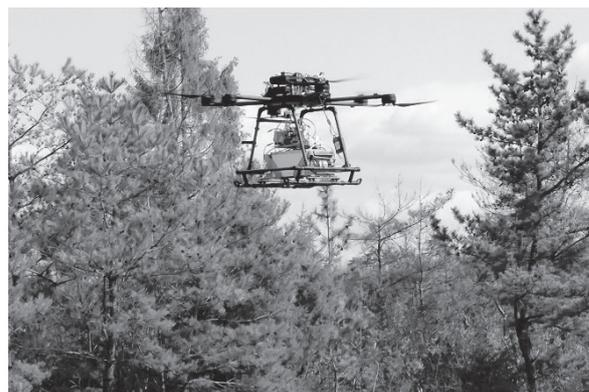
図3 飛行試験中のSOFCドローン
