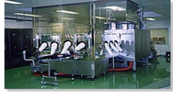
このようなアイソレーターの中に 医薬品の充填ラインなどの装置を設置して、外部環境と隔離して 人(汚染の主たる原因が人間です)が介在することなく無菌状態で作業が行われます。
