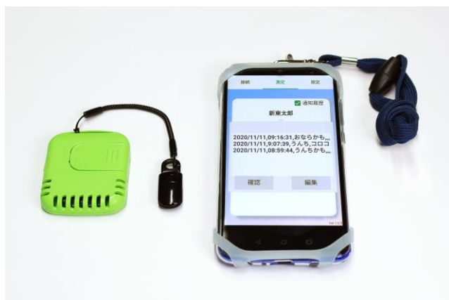
排泄(便・おなら)を検知する排泄センサ(左)と表示端末(右)
